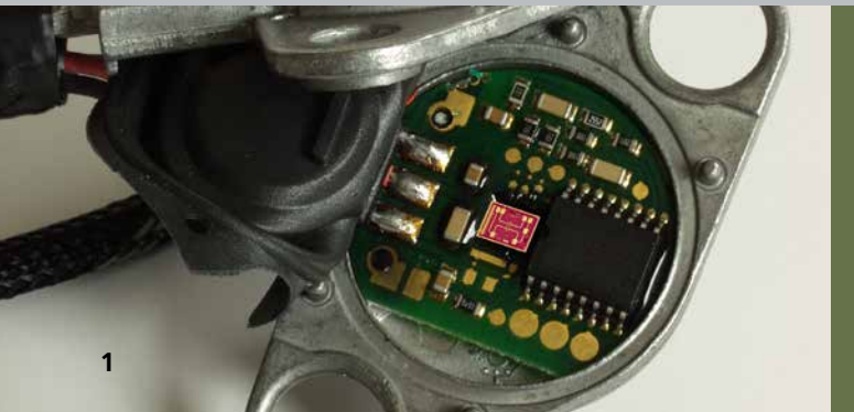
1 Drucksensor mit Ausleseelektronik im Gehäuse für Automotive-Anwendungen.
